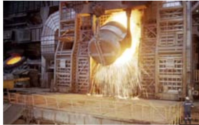
Befüllung eines BOF-Konverters Filling a BOF converter
