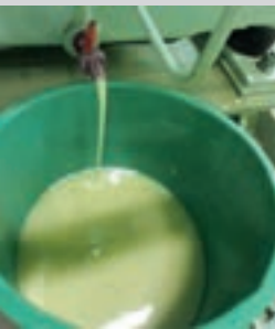
Hohe Wasseranteile im Schmieröl sollten vermieden werden. High content of water in the lube oil must be avoided.
